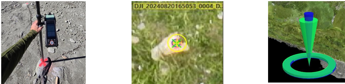
Figure 3 : Marquage manuel, saisie et numérisation des GCP
